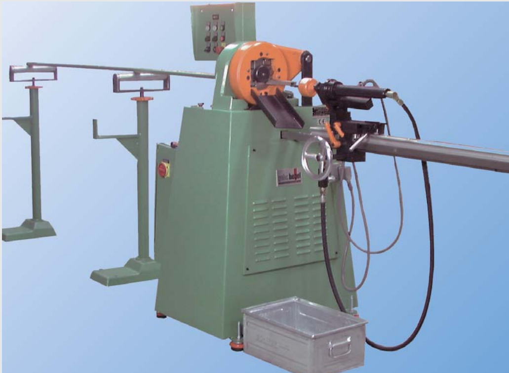
Unsere halbautomatische HEZEL-Ablängmaschine für Klein- und Großserien.
